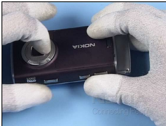
14. Shift open the slider.
