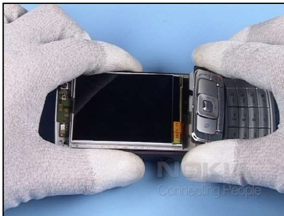
14. Remove the S60 KEYPAD.
